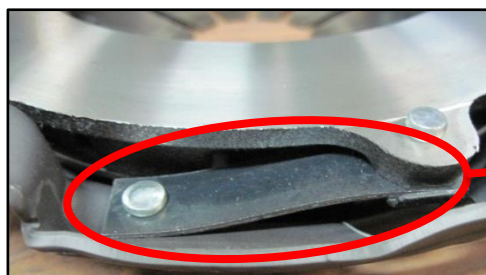
شکل شماره (۲۱) کنترل ایجاد فاصله بین فنرهای تسمه ای
