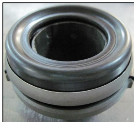
شكل شماره (۵) بلبرینگ كلاچ يك ردیفه نوع اول
