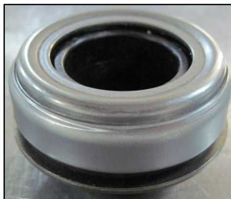
شكل شماره (۶) بلبرینگ كلاچ يك ردیفه نوع دوم
