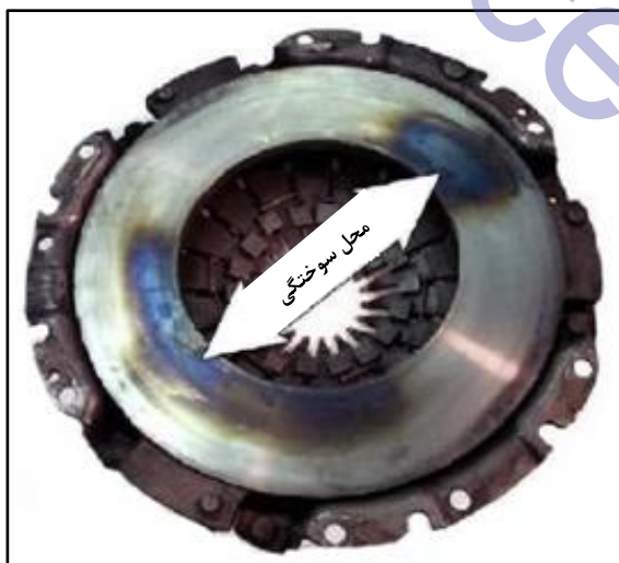
شكل شماره (۲۰) سوختگي يا تغيير رنگ مقطعي
