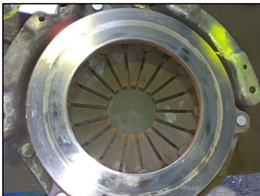
شكل شماره (۱۸) خط افتادگي
