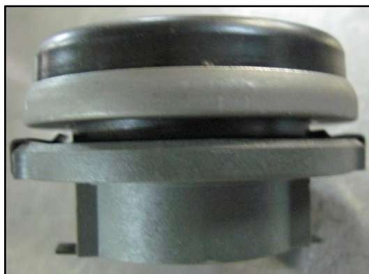
شكل شماره (۵) بلبرینگ كلاچ يك ردیفه نوع اول
